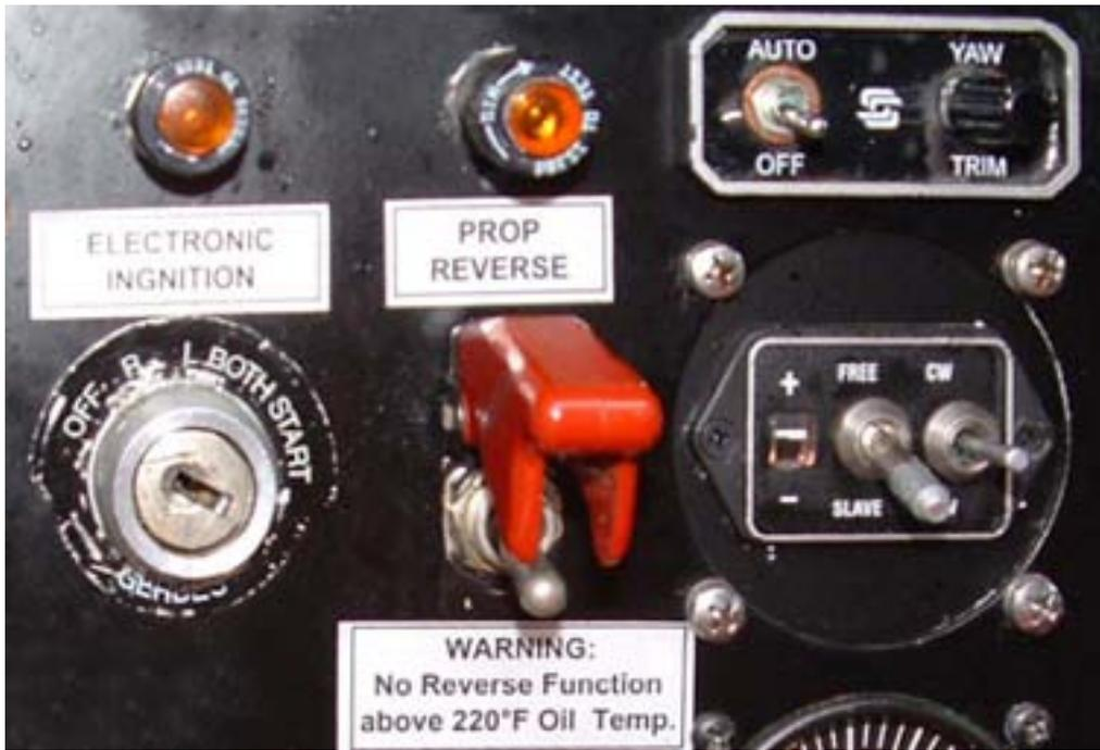
A fianco, il comando del reverse, opportunamente protetto. A sinistra, la spia che segnala il non funzionamento del sistema di accensione elettronica, nel qual caso funziona il sistema normalmente in dotazione. A destra, i pannellini dello yaw dumper e dell'HSI. Qui sotto, la targhetta con il numero di costruzione.
