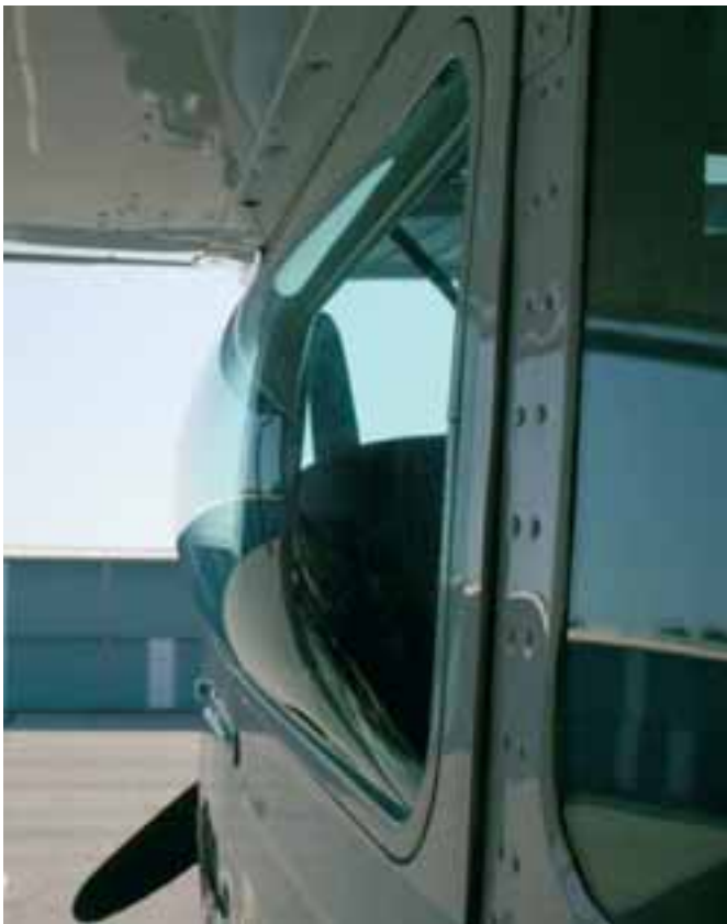
Sopra, finestratura bombata per il pilota. A fianco, un momento dell'ispezione dell'aereo.
