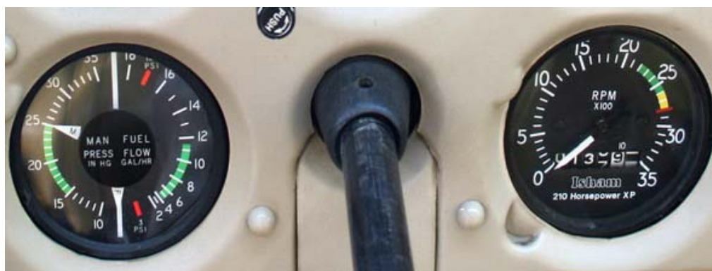
A sinistra, indicatore della pressione di alimentazione e flussometro. A destra, contagiri. Gli strumenti sono attualmente quelli previsti nella conversione Isham (si noti la tacca rossa a 2800 giri).
